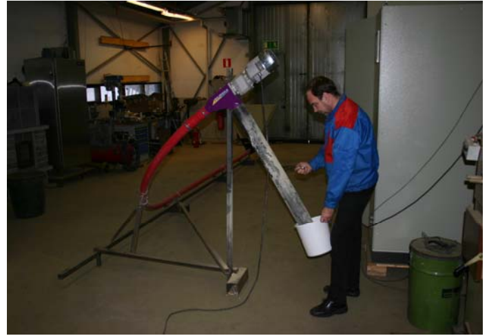
Kuva 3. 7,3 m pituinen Murska siirtoruuvi kylmäsyöttökokeessa Työtehoseuran lämpökoeasemalla
