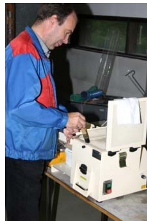
Kuva 1. LT II –laitetta valmistellaan puupelletin käsittelykestävyyden kokeeseen.
